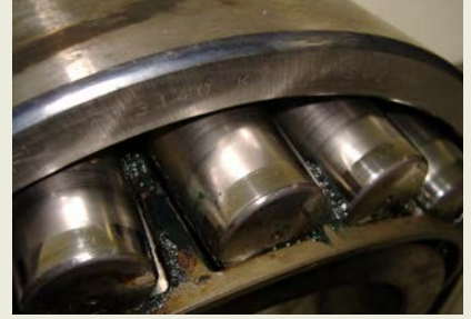
Bu CARB toroid rulmanlar, bir şeker fabrikası egzoz fanında 10 yıl çalıştıktan sonra bile üstün performans sunmaktadır.
