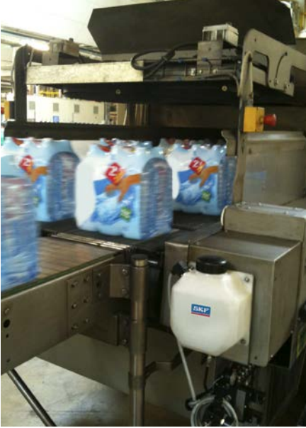
Ambalajlama makinaları, paletleyiciler, şrink film makinaları ve benzerlerinde zincirlerin yağlanması için.
