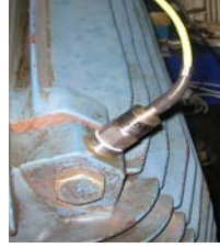
Belirlenen noktaları izleyen SKF sensörleri ve SKF IMx online takip sistemi
